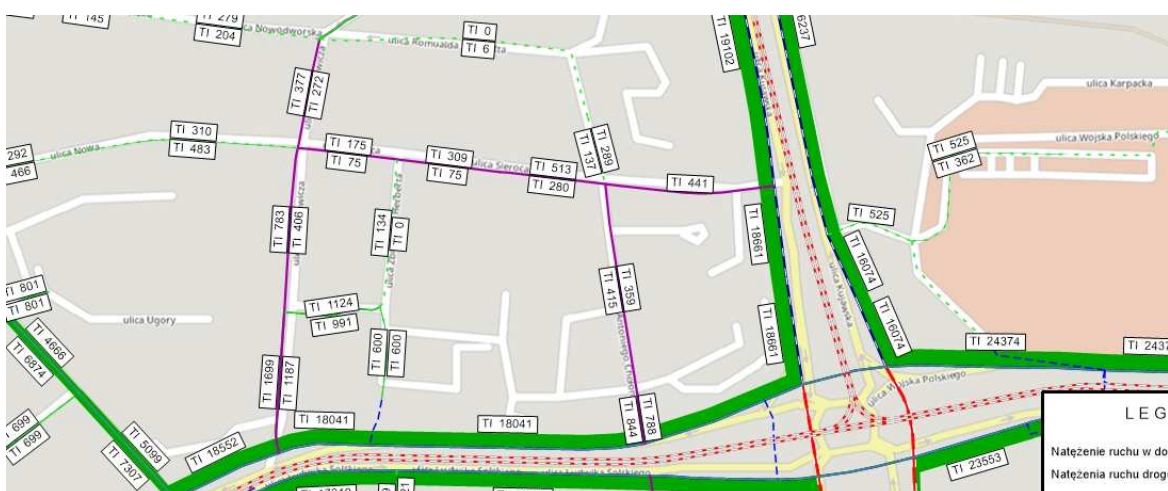
Rys. nr 2 Natężenia ruchu z programu Visum – model przedstawia sytuację drogowo – ruchową po wprowadzeniu zmiany w organizacji ruchu polegającej na wykluczeniu relacji w prawo z ul. Sierociej w ul. Kujawską
